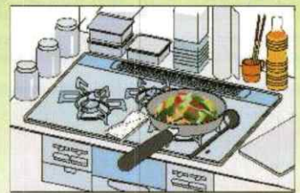
周辺に可燃物が置かれた危険な例
