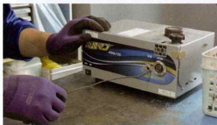
線材の被覆除去作業
